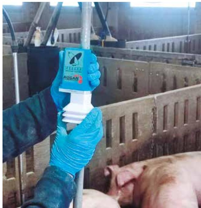
Los sensores de Aугan se ubican a nivel cabeza del ganado para control de gases y condiciones ambientales. Foto: Aугan y UnaBiz.
